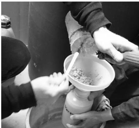
Abb. 4: Befüllen der Probenflasche und Auskratzen von Festanteilen mit Teigspachtel
