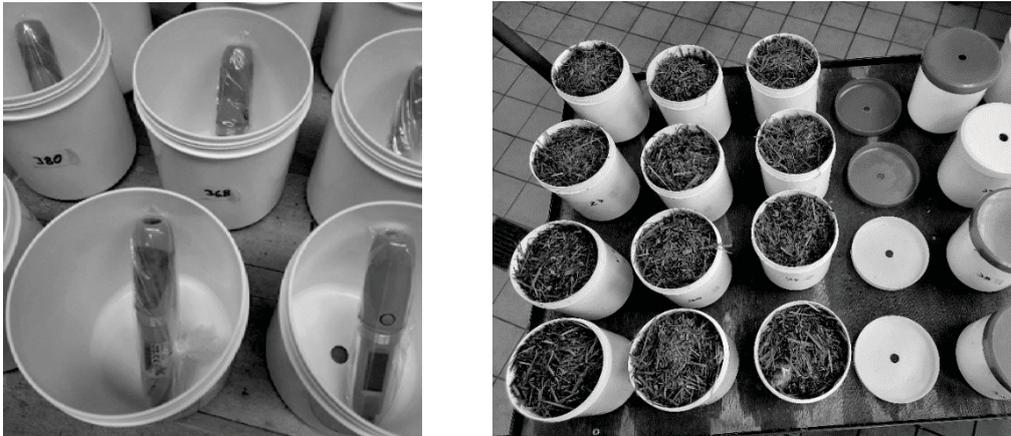
Abbildung 1: Becher für den Test auf aerobe Stabilität, leer mit Temperaturloggern (links) bzw. gefüllt mit der unterschiedlich behandelten Mischration (rechts)
